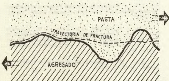
B) FALLA PRODUCIDA POR CORTANTE
