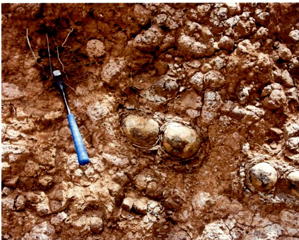
Foto No. 36: Meteorización esférica de „andesitas inferiores“, volcán Juana Pancha. En varias localidades, este tipo de descomposición se convierte en tipo laminar.
