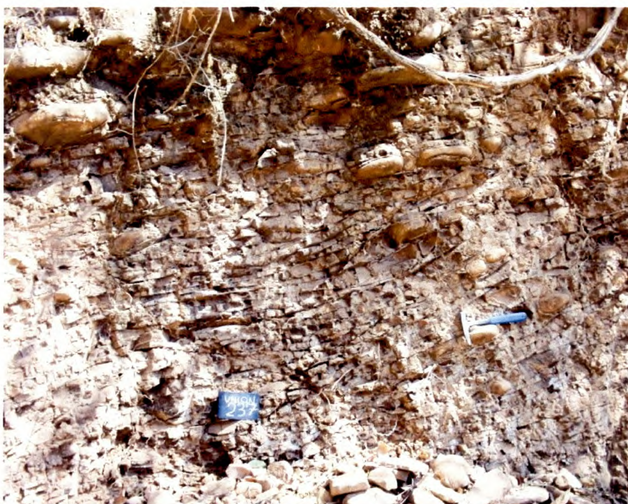
Foto No. 44: Descomposición laminar de andesita basáltica, parte central del área estudiada.
