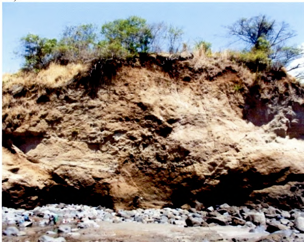
Foto No. 75: La capa de la toba clara, suave entre dos coladas de andesitas puede jugar un papel negativo en caso de deslizamientos (alteración, capa acuifera). PdeR 370).
