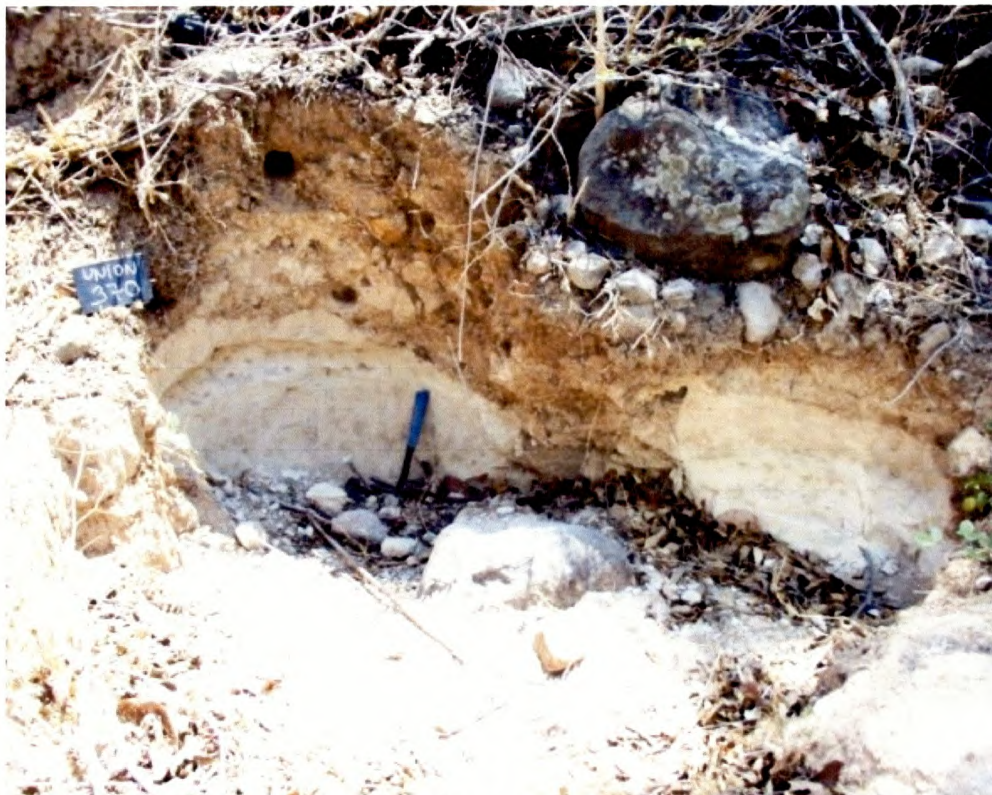
Foto No. 75: La capa de la toba clara, suave entre dos coladas de andesitas puede jugar un papel negativo en caso de deslizamientos (alteración, capa acuifera). PdeR 370).
