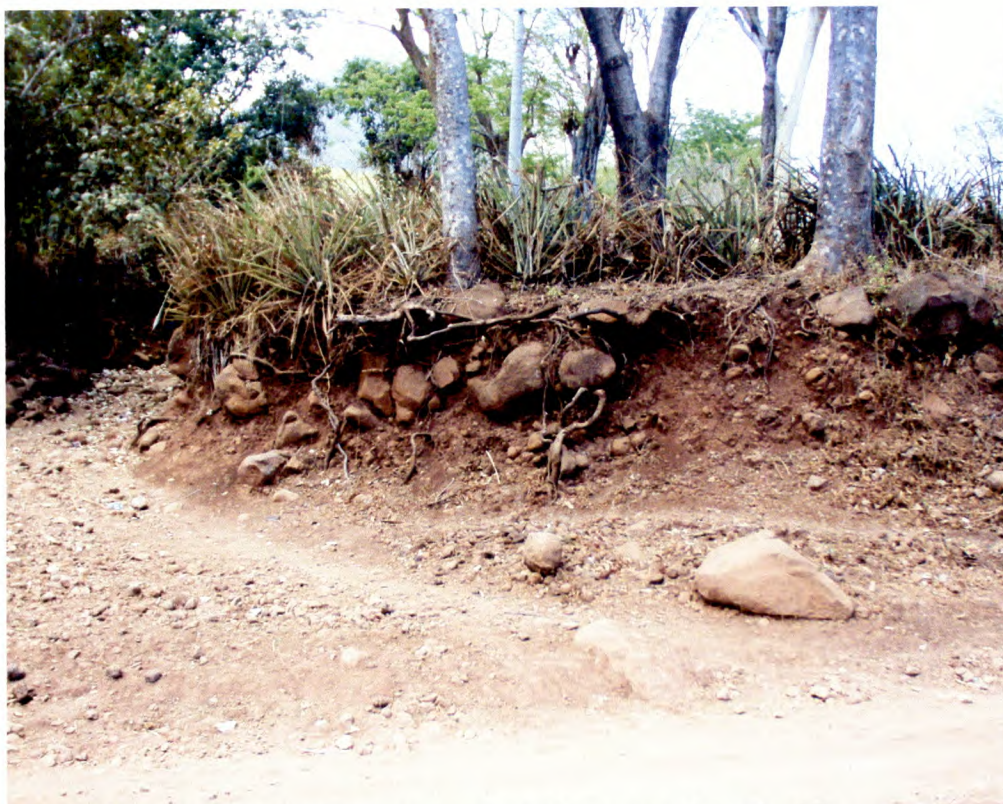
Foto No. 63: Gravas arenosa gruesas, cáoticamente depositadas en cono deyección menor, Los Chorros.
