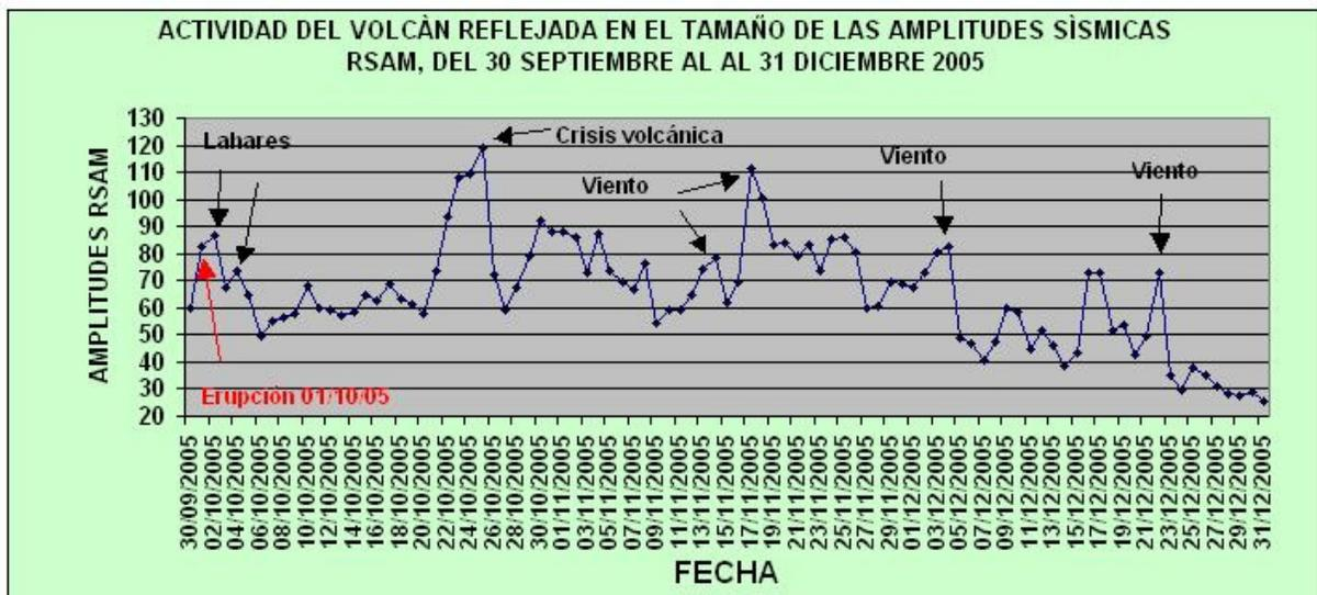
**Figura 31.** Nivel de energía sísmica del volcán de Santa Ana, desde un día antes de la erupción (01/10/05), hasta el 31 diciembre de 2005. Algunos de los picos que se observan en la gráfica señalados con flechas, no obedecen del todo a la actividad del volcán, si no que en gran medida a vibración originada en el terreno por efecto de los vientos de la época.
