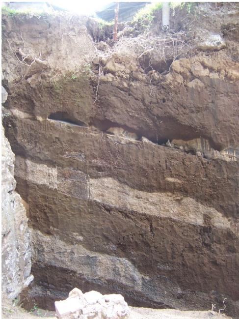
Fig. 7 capas de piroclastos escoriáceos gris oscuro, alternados con tobas café.
