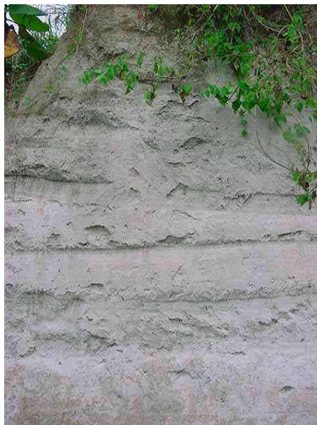
Perfil zona Cumbres de Cuscatlán. Gruesos estratos de ceniza volcánica pomicítica. Material predominante en el área de la cuenca.
