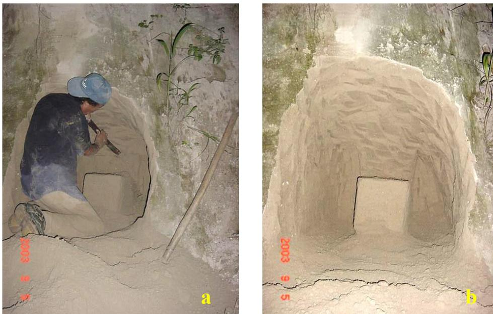
Figura 6. a) Extracción de muestra inalterada C2 en la Unidad C. b) Penetración de 60 cm dentro de la cara del talud para obtención de cubo de tamaño de 25 cm por lado.
