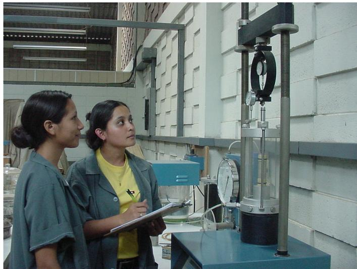
Figura 8. Ensayo de compresión triaxial Q (UU) no consolidado-no drenado, para la determinación del ángulo de fricción interna y cohesión.
