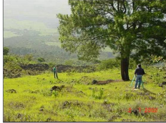
Fotografía núm. 7: Nivelación de bancos de marca para el monitoreo de deformaciones en flanco norte del volcán de San Salvador.
