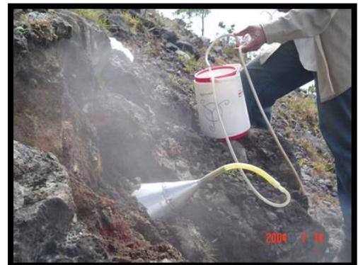
Esquema del volcán de Izalco que muestra el sitio de toma de condensado en la fumarola 3 del borde norte. A la derecha la foto 15, muestra el equipo en el momento de la toma del condensado
