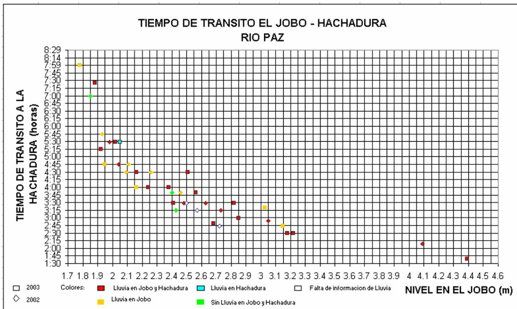
**Figura 1. Tiempos de Tránsito entre las estaciones El Jobo y La Hachadura.**
