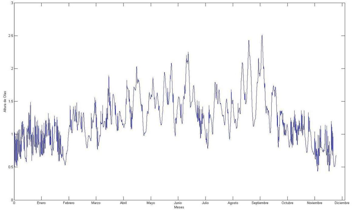
Figura A.17. Altura de oleaje (metros) vs. Tiempo (meses) del 2005.
