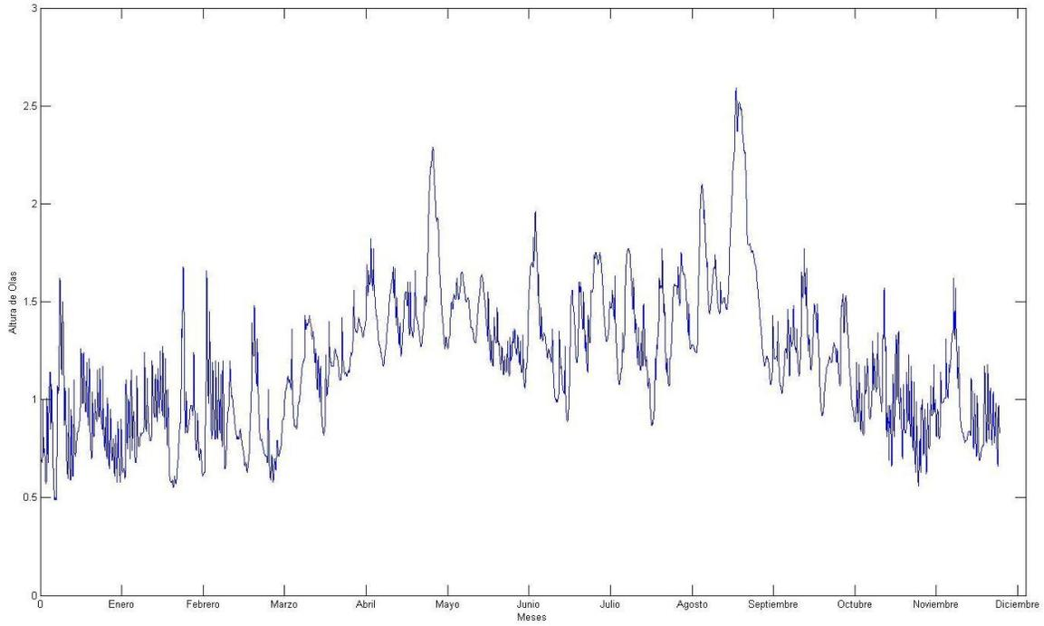
Figura A.11. Altura de oleaje (metros) vs. Tiempo (meses) del 2002.
