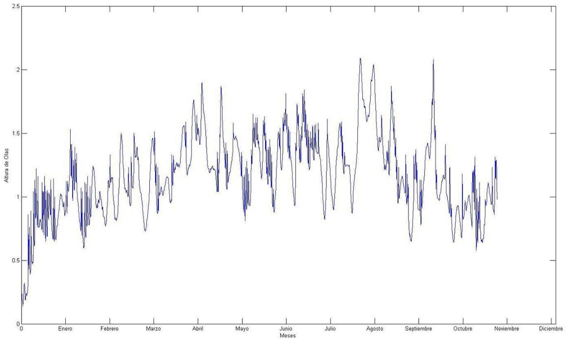
Figura A.1. Altura de oleaje (metros) vs. Tiempo (meses) de 1997.
