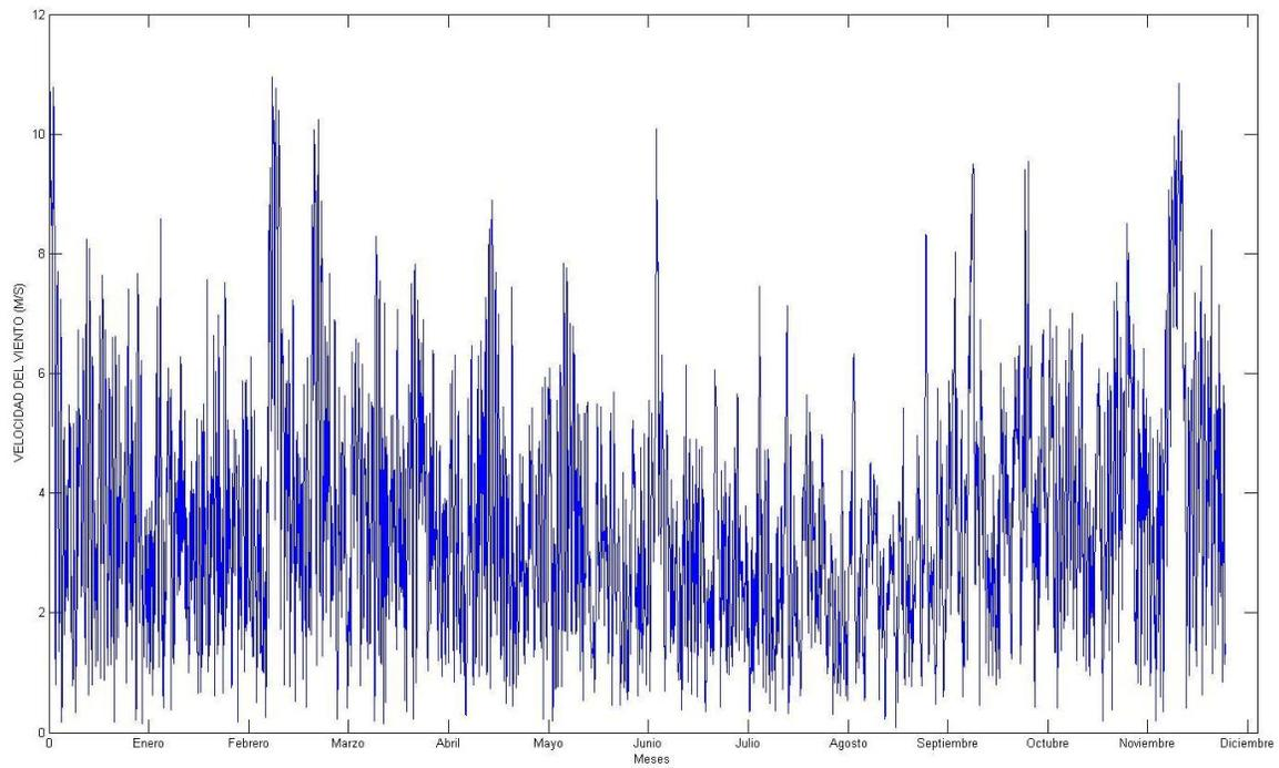
Figura A.4. Velocidad del viento (metros/segundo) vs. Tiempo (meses) de 1998.
