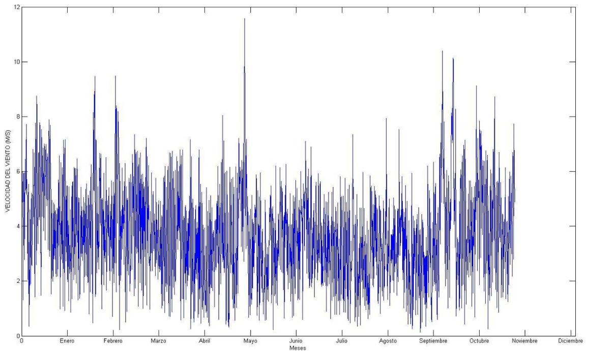
Figura A.22. Velocidad del viento (metros/segundo) vs. Tiempo (meses) del 2007.
