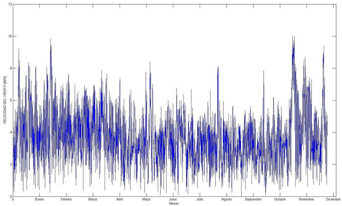
Figura A.20. Velocidad del viento (metros/segundo) vs. Tiempo (meses) del 2006.
