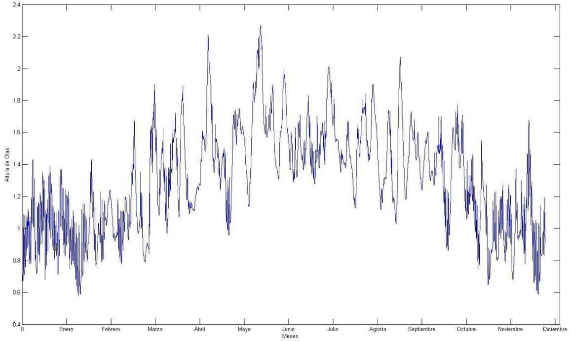
Figura A.13. Altura de oleaje (metros) vs. Tiempo (meses) del 2003.
