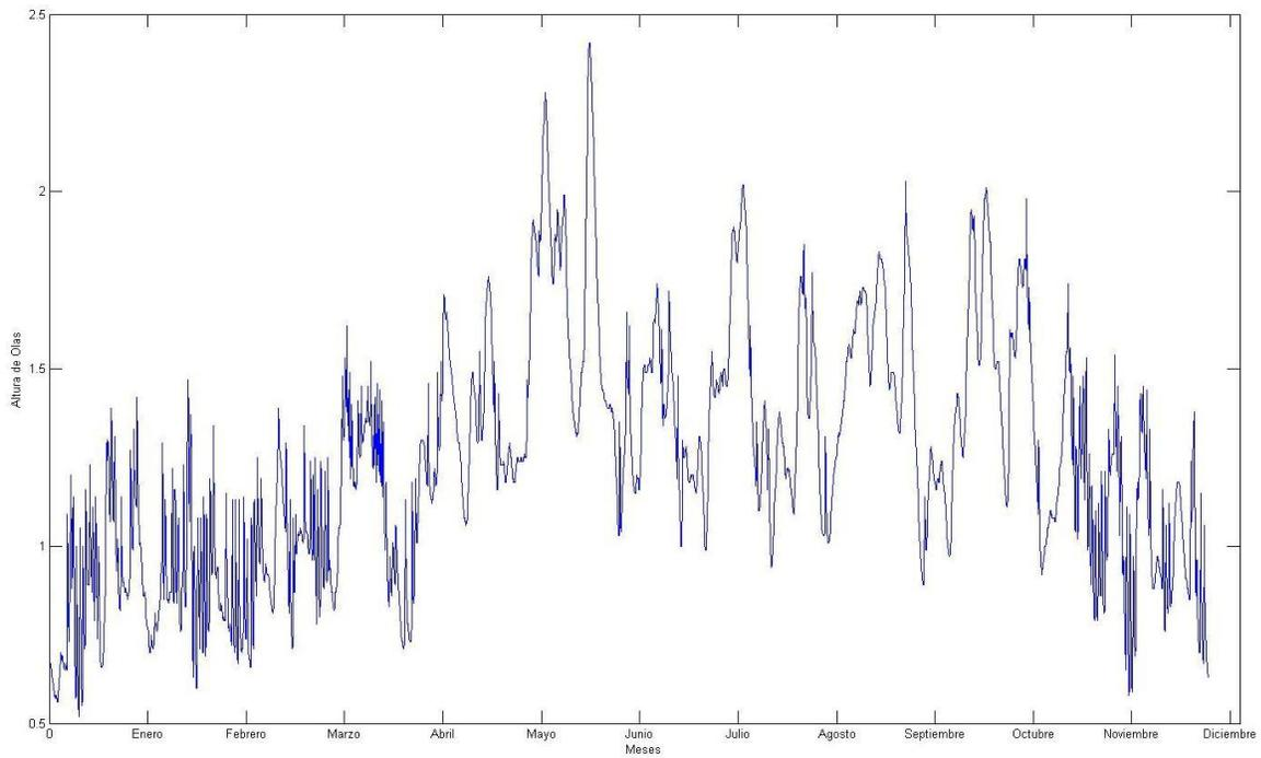
Figura A.19. Altura de oleaje (metros) vs. Tiempo (meses) del 2006.
