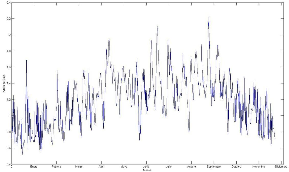
Figura A.9. Altura de oleaje (metros) vs. Tiempo (meses) del 2001.
