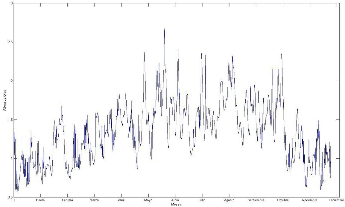
Figura A.3. Altura de oleaje (metros) vs. Tiempo (meses) de 1998.
