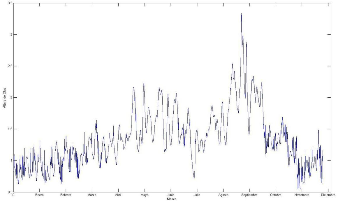
Figura A.5. Altura de oleaje (metros) vs. Tiempo (meses) de 1999.
