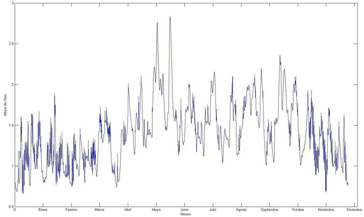
Figura B.19. Altura de oleaje (metros) vs. Tiempo (meses) del 2006.
