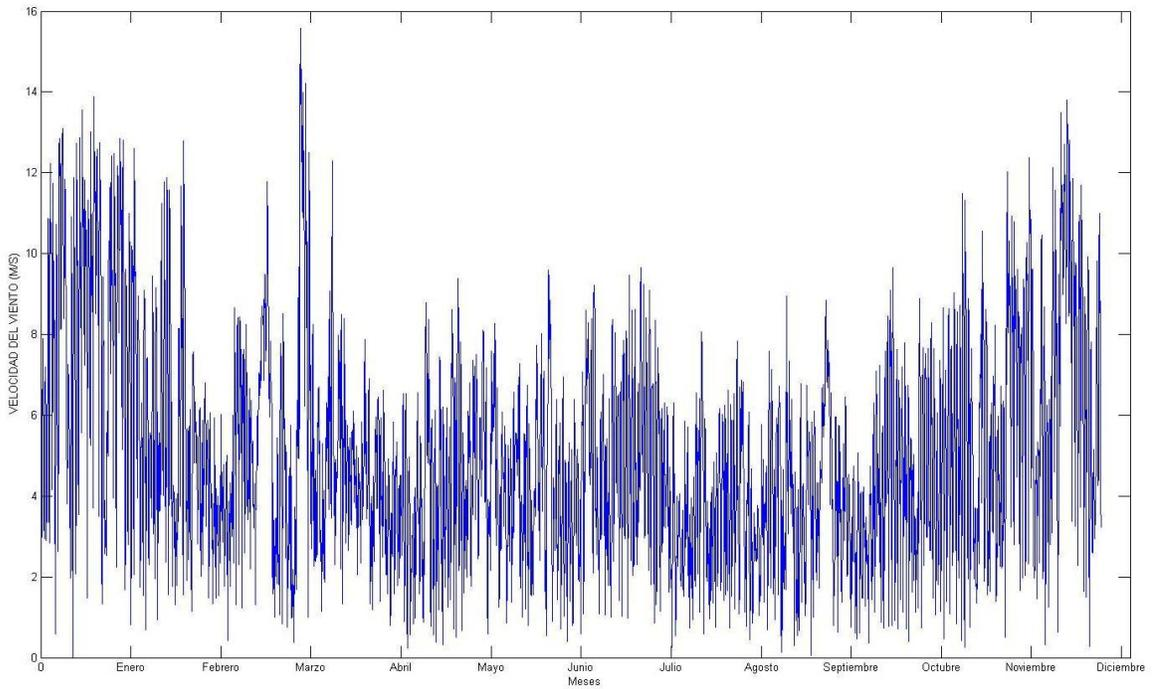
Figura B.14. Velocidad del viento (metros/segundo) vs. Tiempo (meses) del 2003.
