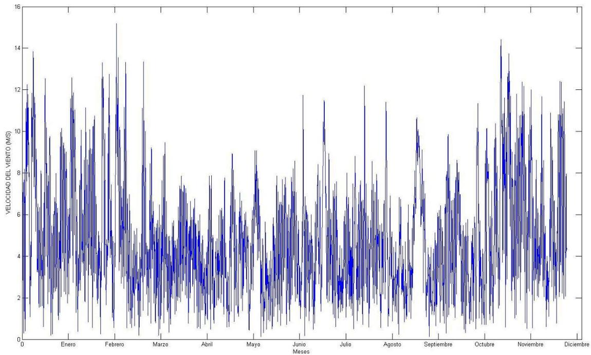
Figura B.12. Velocidad del viento (metros/segundo) vs. Tiempo (meses) del 2002.
