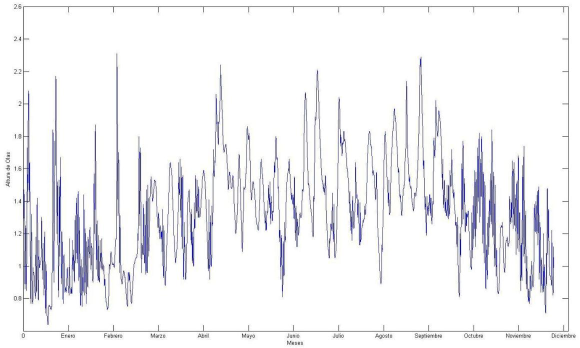
Figura B.9. Altura de oleaje (metros) vs. Tiempo (meses) del 2001.
