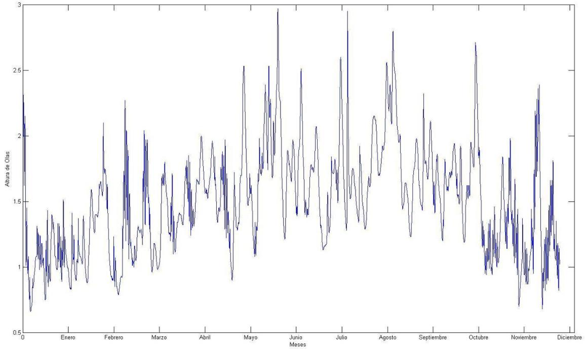
Figura B.3. Altura de oleaje (metros) vs. Tiempo (meses) de 1998.
