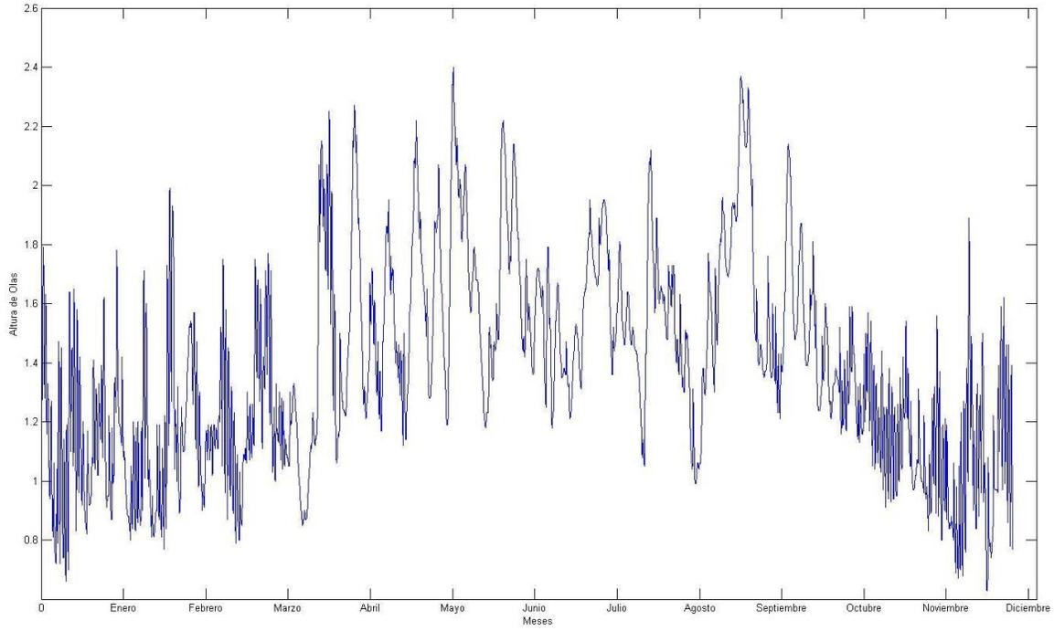
Figura B.15. Altura de oleaje (metros) vs. Tiempo (meses) del 2004.
