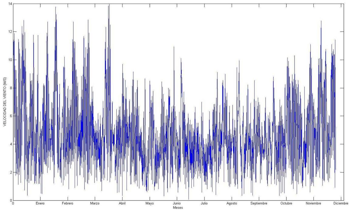
Figura B.16. Velocidad del viento (metros/segundo) vs. Tiempo (meses) del 2004.
