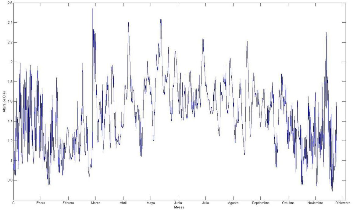
Figura B.13. Altura de oleaje (metros) vs. Tiempo (meses) del 2003.
