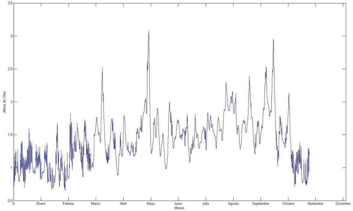
Figura B.21. Altura de oleaje (metros) vs. Tiempo (meses) del 2007.
