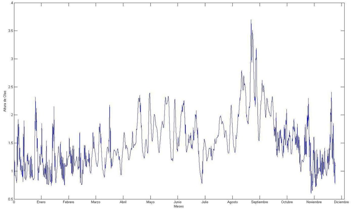
Figura B.5. Altura de oleaje (metros) vs. tiempo (meses) de 1999.
