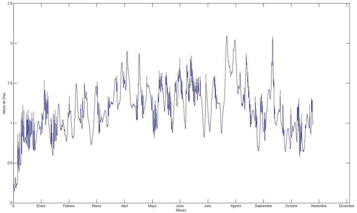
Figura B.1. Altura de oleaje (metros) vs. Tiempo (meses) de 1997.
