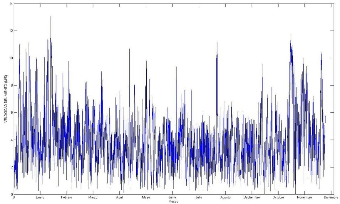
Figura B.20. Velocidad del viento (metros/segundo) vs. Tiempo (meses) del 2006.
