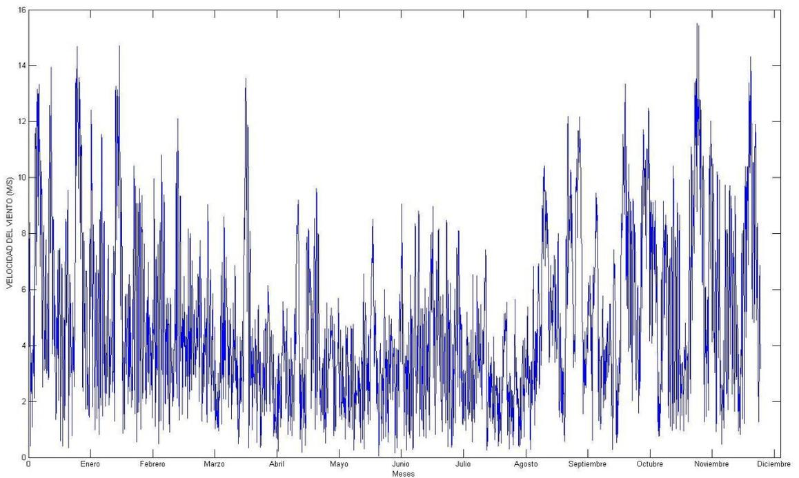
Figura B.6 Velocidad del viento (metros/segundo) vs. Tiempo (meses) de 1999.
