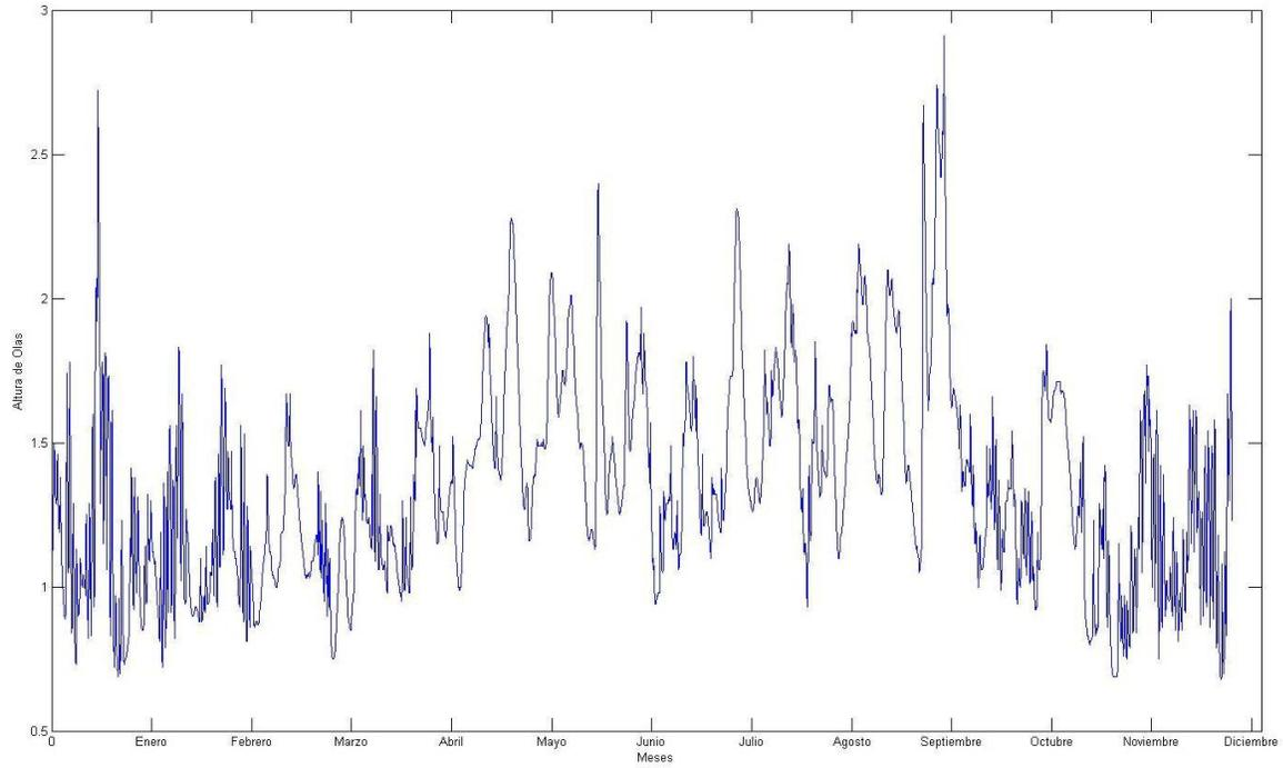
Figura B.7. Altura de oleaje (metros) vs. Tiempo (meses) del 2000.
