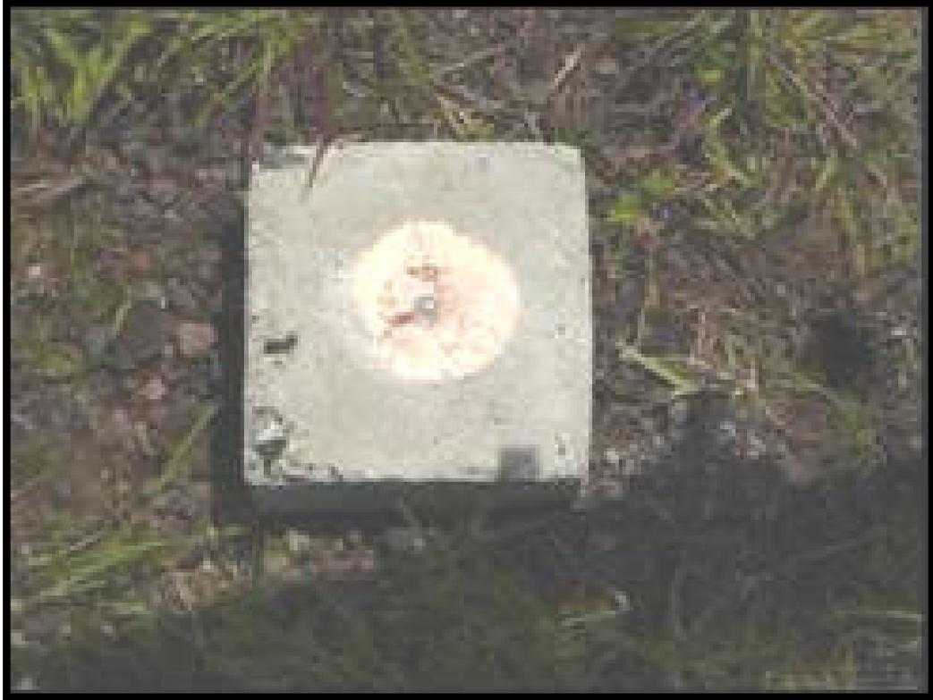
Fotografía 1. Banco de marca construido para la red de monitoreo Geodésico.
