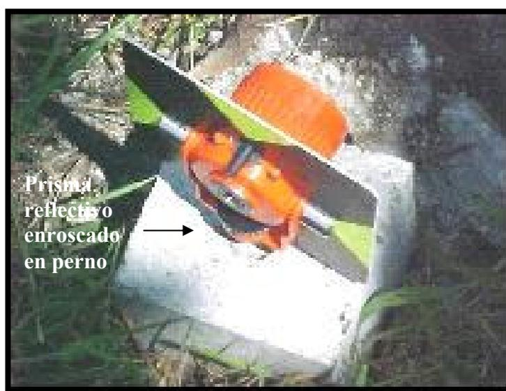
Fotografía 19. Banco de marca con prisma instalado.
