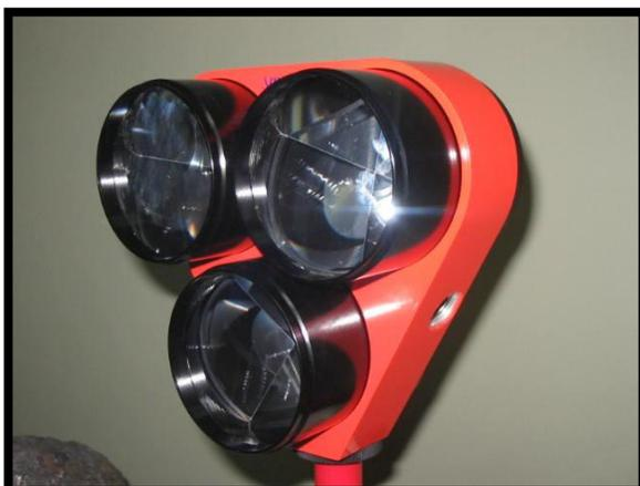
Fotografía 24. Prisma Triple usado con la Estación.
