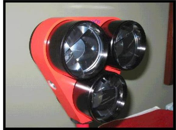
Fotografía 21. Prisma triple para la Estación Total.
