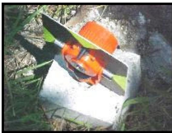
Fotografía 25. Prisma Sencillo usado con la Estación.
