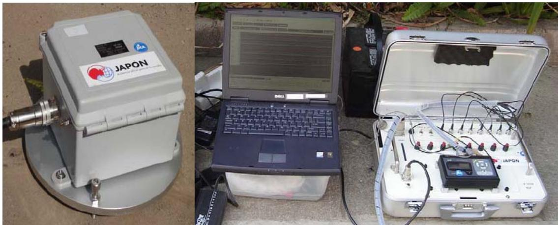
**Figura 3.6: Equipo para medición de Microtemblores: Sensor de Aceleración (izq.), computadora portátil (centro) y amplificador de señal (der.) [Reyes y Sorto, 2007]**
