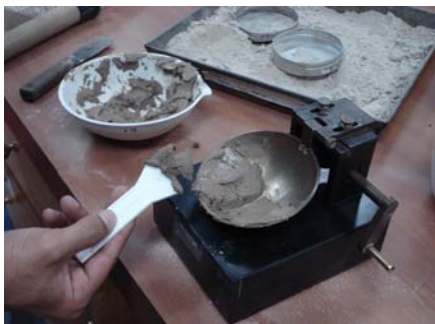
Figura 4.8. Moldeado de la muestra en la copa de Casagrande
