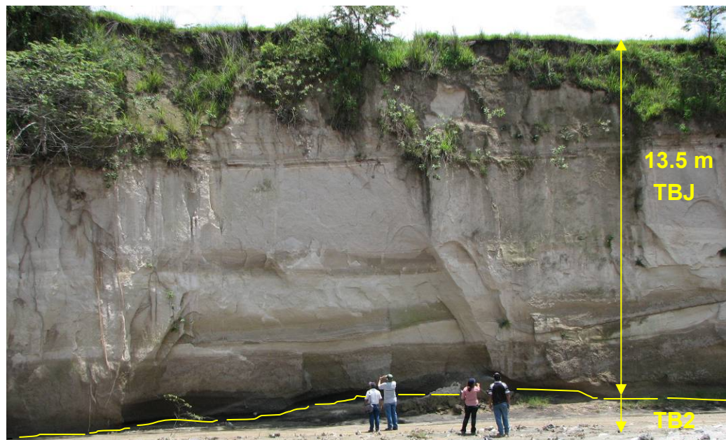
Figura 3.5. Perfil estratigráfico de la TBJ en un talud ubicado en Arenal San Bartolo [Junio, 2009].
