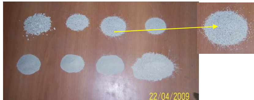
Figura 4.10. Muestras retenidas en cada tamiz del punto 1-A.
