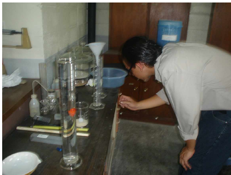
Figura 4. 2 Proceso de calibración en el Ensayo del hidrómetro.
