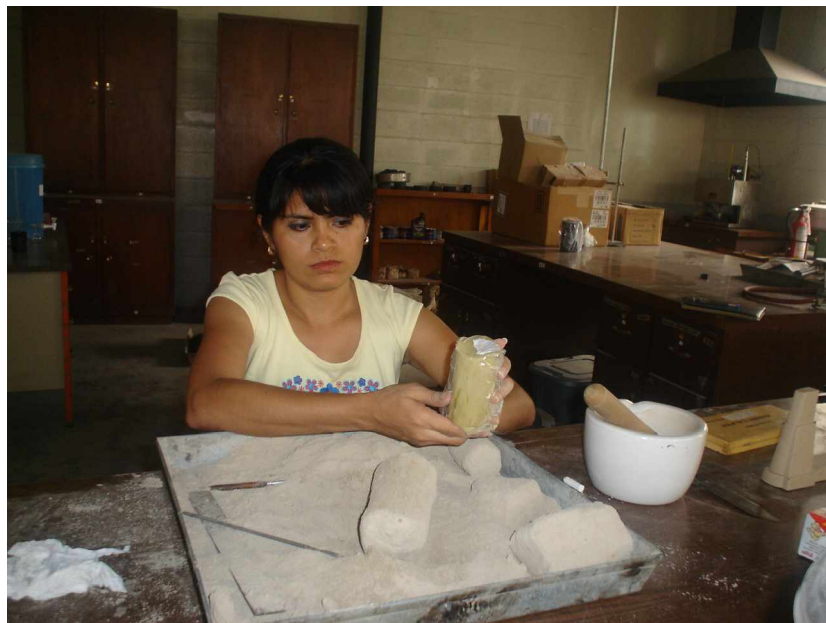
Figura 4. 3 Elaboración de la probeta para el Ensayo Triaxial.
