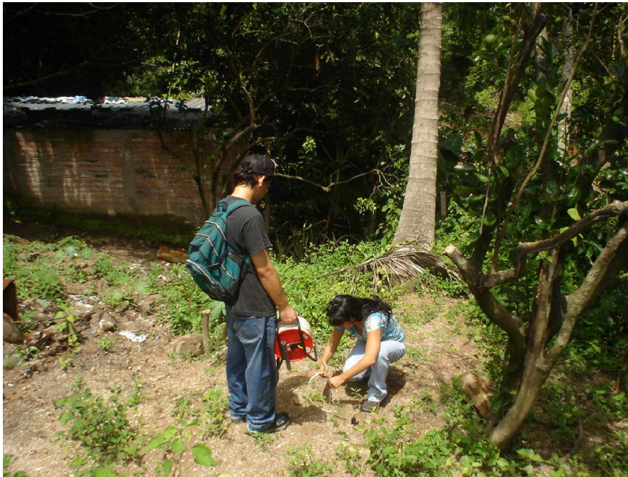
Figura 2. 11 Sonda eléctrica para la medición de la profundidad del nivel del agua subsuperficial.
