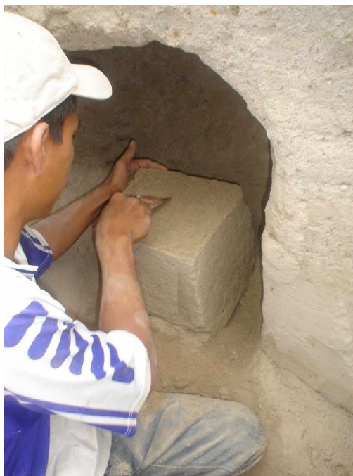
Figura 4. 1 Extracción de muestra inalterada en el talud de la col. Brisas del Sur.
