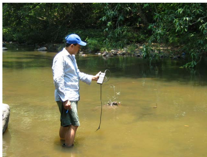
Medición de Oxígeno Disuelto en A-01-QUEZA
