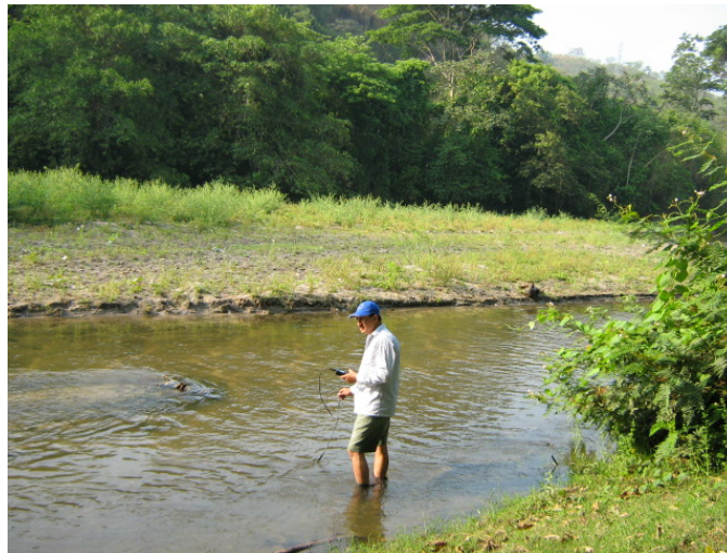
Medición de Oxígeno Disuelto en el sitio de muestreo A-01-SUCIO
